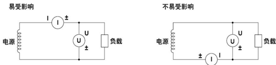
图 5.32 降低杂散电容对测量精度的影响
