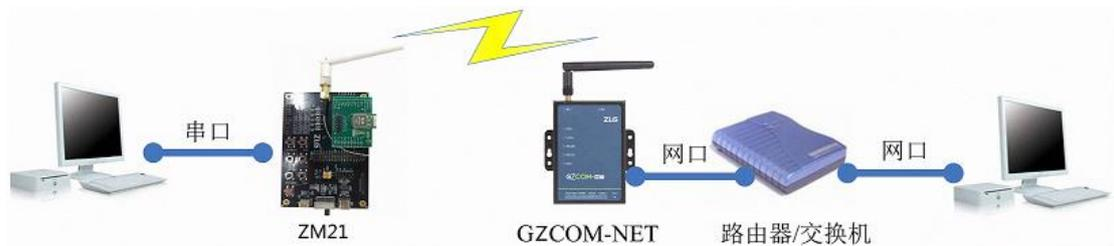
图 3.1 硬件连接示意图
