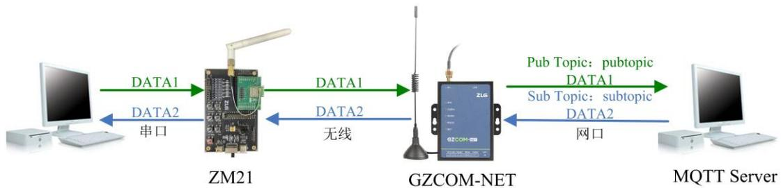
图 4.7 无线与 MQTT 透传应用示意图
