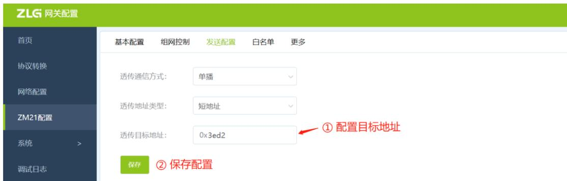
图 3.21 ZigBee 发送配置
