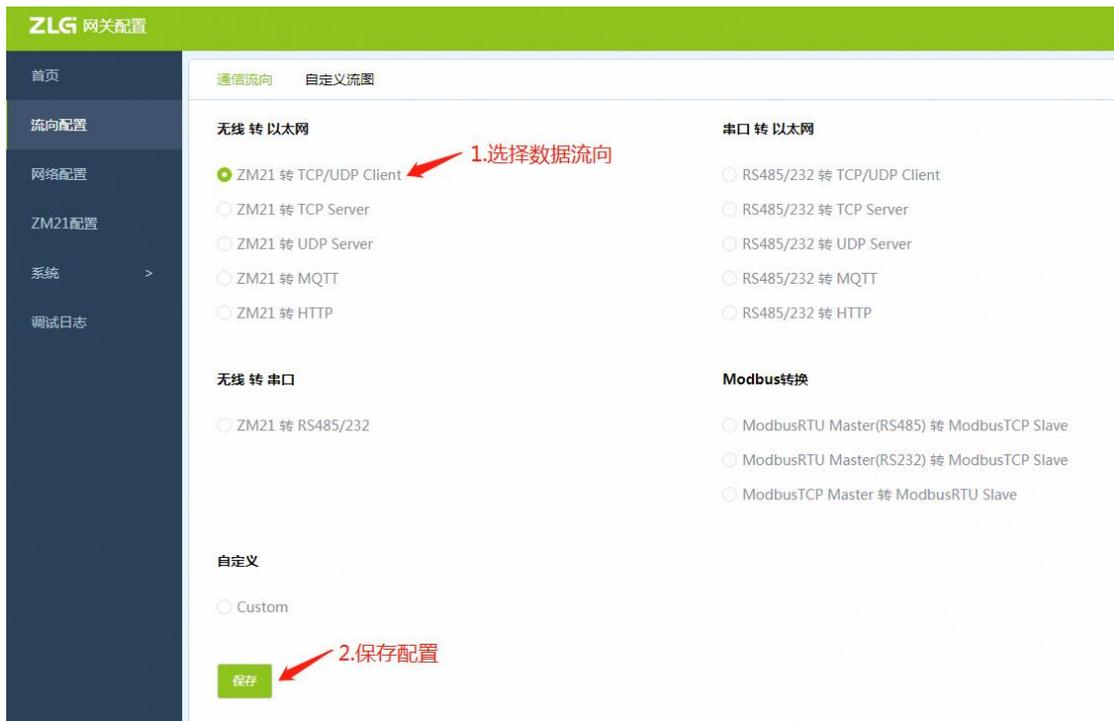
图 3.12 选择 ZigBee 转 TCP/UDP Client
