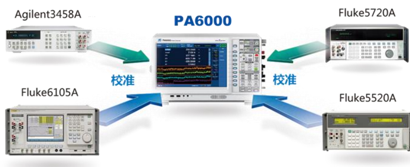
图 1.27 PA6000 功率分析仪校准体系
