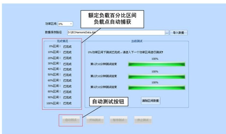
图 1.5 PAM 软件自动测量功能
