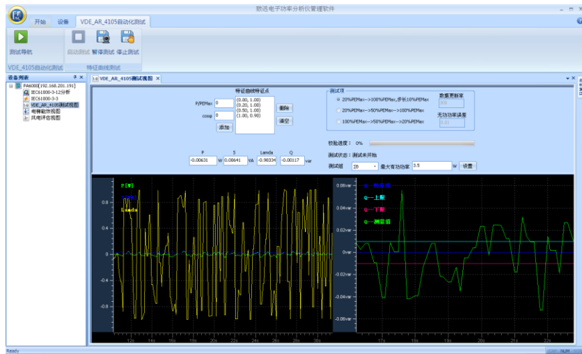
图 1.7 PAM 软件功率因数和有功功率特征曲线测试功能
