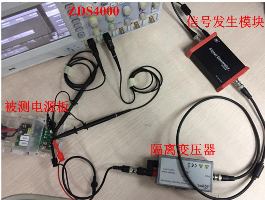
图 2.2 同步测试实物连接
