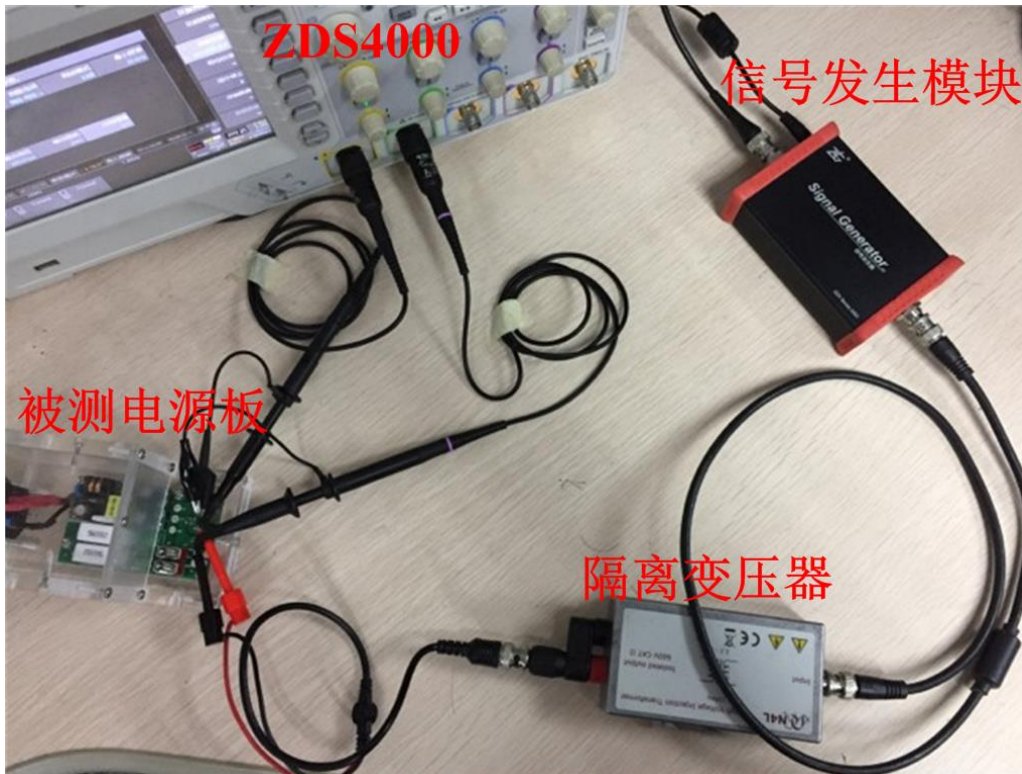
图 3.4 环路测试实物连接
