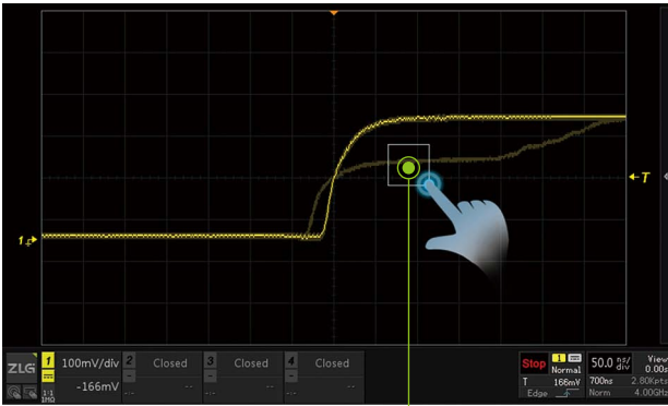
全面支持两点触摸，轻松进行区域触发
