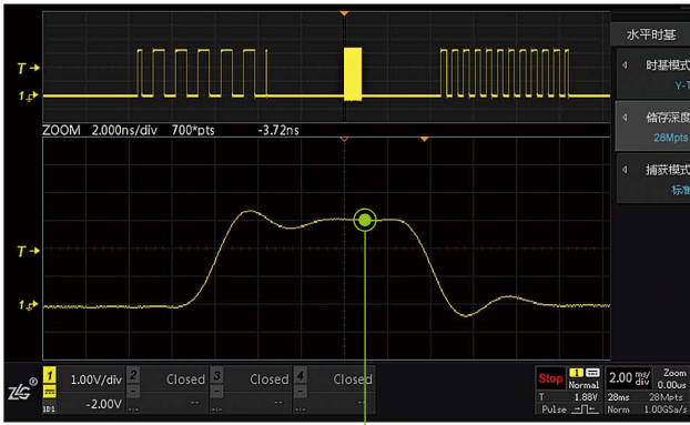
28M 存储深度下，采样率保持在 1G，波形细节清晰可见
