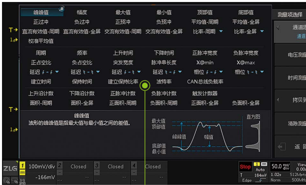
支持 54 种参数测量项, 24 种参数测量同屏显示
