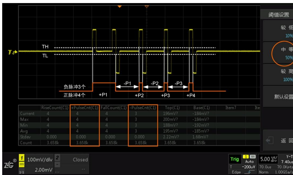
图 7.6 默认正负脉冲个数测量说明
