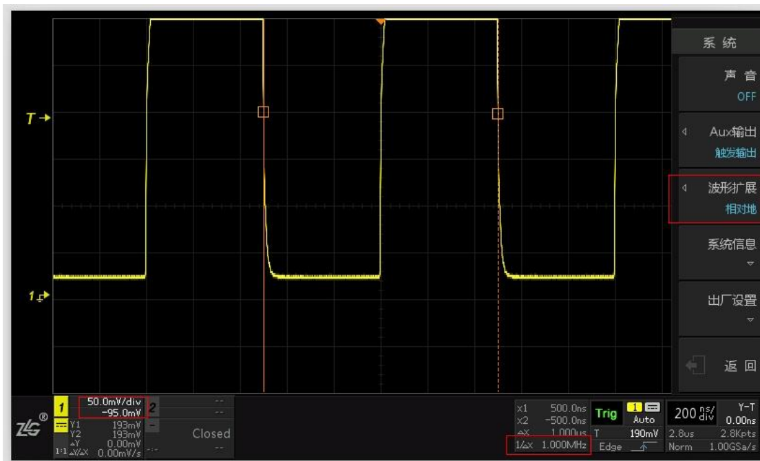
图 3.8 相对地扩展的 50mV/div 档位波形显示
