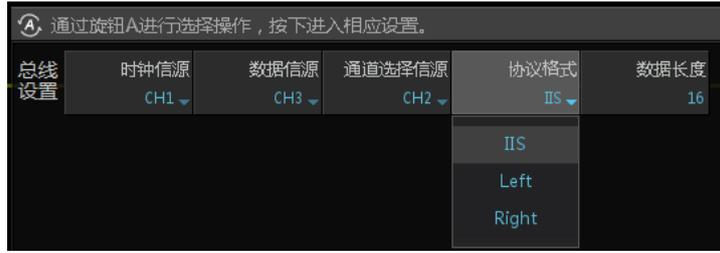
图 2.2 I2S 解码参数设置
