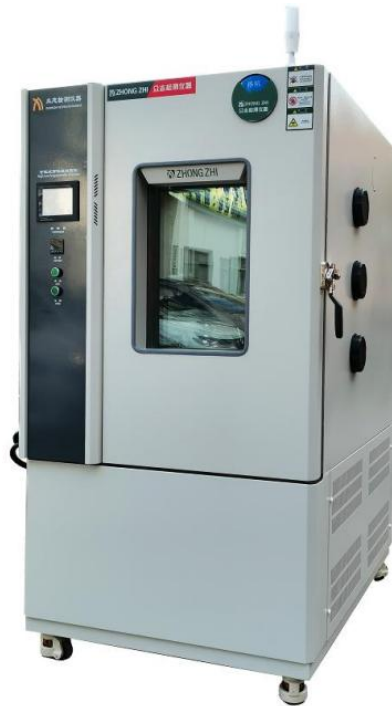
图 1 CZ-A-225G 高低温湿热试验箱
