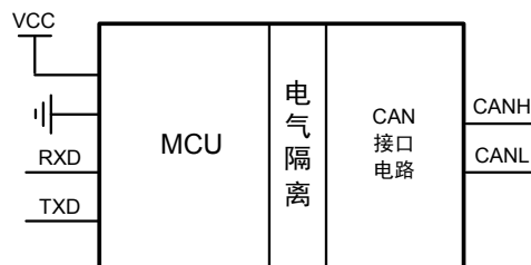
图 1 CSM100 系列模块的功能框图
