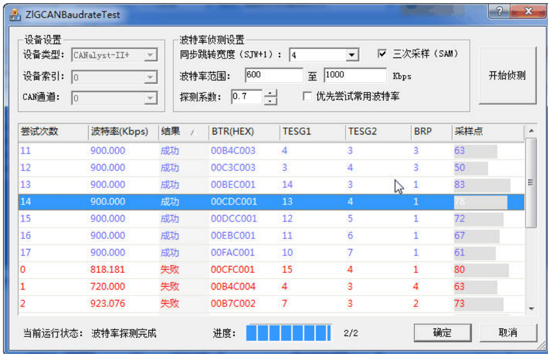
图 2.2 CAN 波特率自动探测操作
