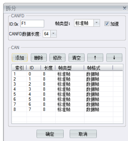
图 4.36 64 字节 CANFD 拆分 8 个 8 字节 CAN 设置
