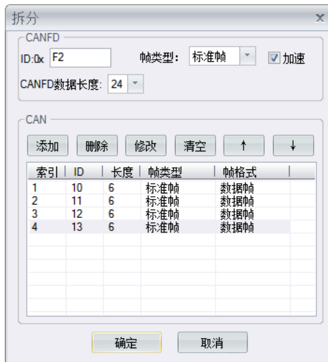
图 4.38 24 字节 CANFD 拆分为 4 个 6 字节 CAN 设置
