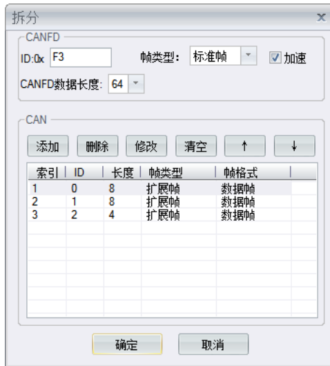
图 4.40 64 字节 CANFD 拆分为 2 个 8 字节 CAN 设置
